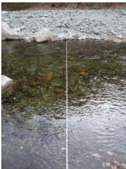
図 1.4.1 設置した側線。側線は調査対象地点の周辺において代表的な流況、河床構造を示す場所に設定した。
