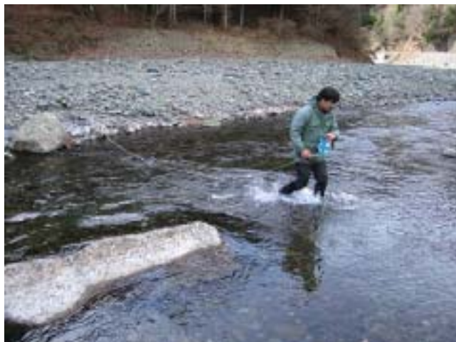
図 1.4.1 調査対象地点において側線を設置し、流速および水深の計測を行った。
