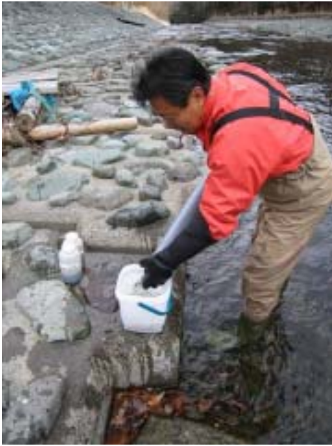
図 1.4.3 柱状に採取した底質は、漏れないように塩ビ管の両端を手で押さえて確保し、分析用サンプルとした。
