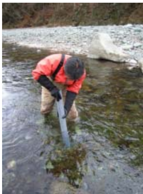
図 1.4.3 採泥は \phi 120mm の塩ビ管を用い、河床面より 0.15m 下の層までを採取した。
