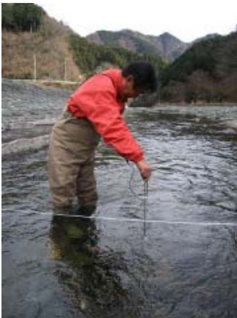
図 1.4.3 流速の計測。水深の 1/2 の水深における流速を測定した。サンプリングの位置は水深計測と同様。
