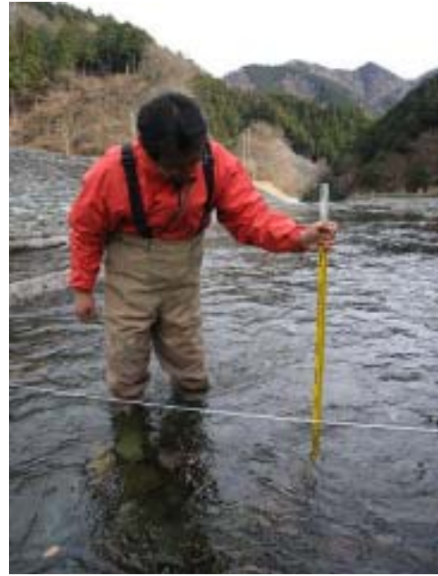
図 1.4.3 水深の計測。河床の起伏の少ない調査地点では 1m、起伏のある河床では 0.5m 毎に水深を記録した。
