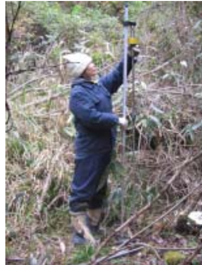
写真-15 貫入試験の様子
